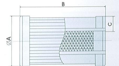
SUCTION LINE FILTER DRIER CORES 干燥过滤芯
